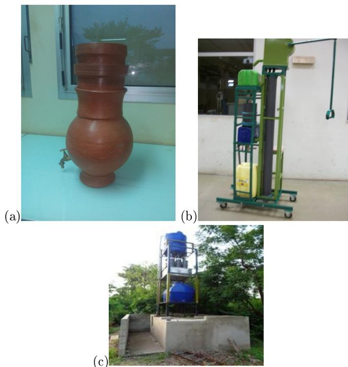
FIGURE 2 – Photographies des différents prototypes réalisées pour la purification de l'eau. (a) Familial; (b) Laboratoire; (c) Préindustriel.
